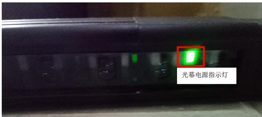
**注意：** A、若光幕中间无遮挡时光幕遮挡指示灯亮，表示光幕未对正；
