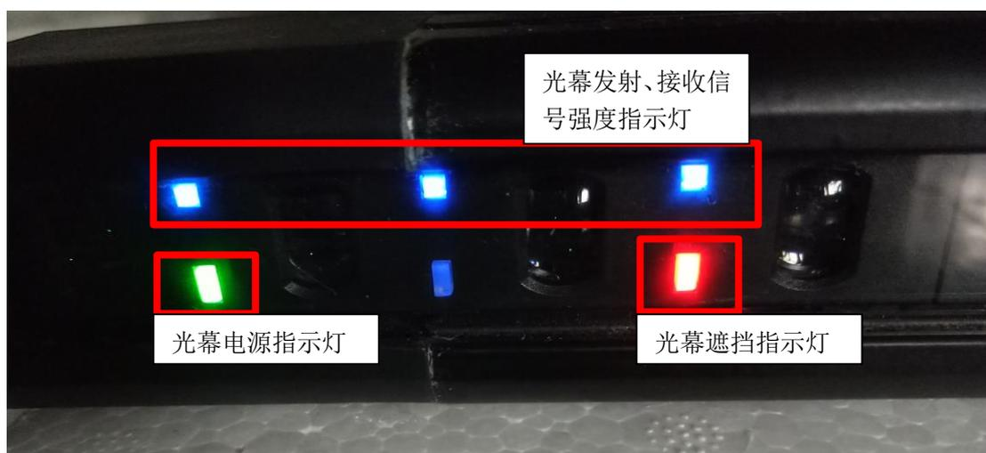
两种情况下发射端指示灯仅亮电源指示灯，实际现象如下图所示：
