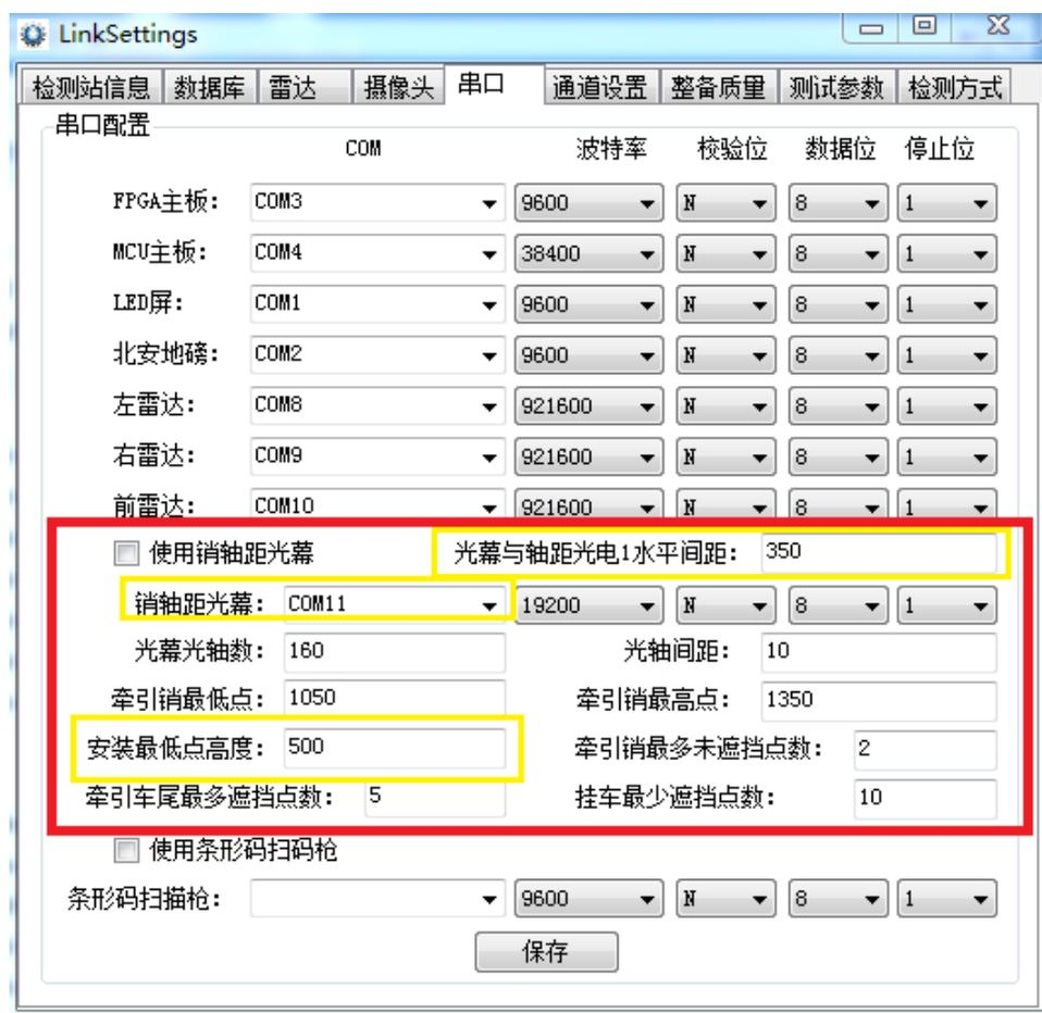
**特别注意：光幕光轴数及光轴间距请仔细确认，一般配置为 160/10 或 80/20，请使用直尺测量一下两个光轴之间的间距后填写！**
