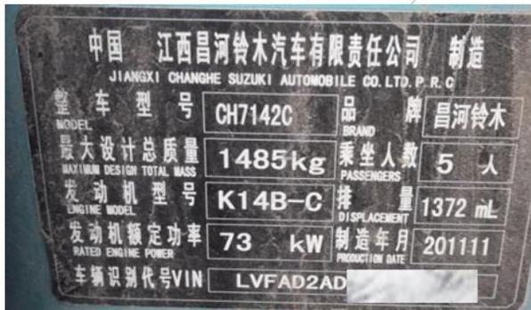
◆昌河铃木，派喜(SPLASH)，2011年11月出厂，整车型号CH7142C，发动机型号K14B-C。
