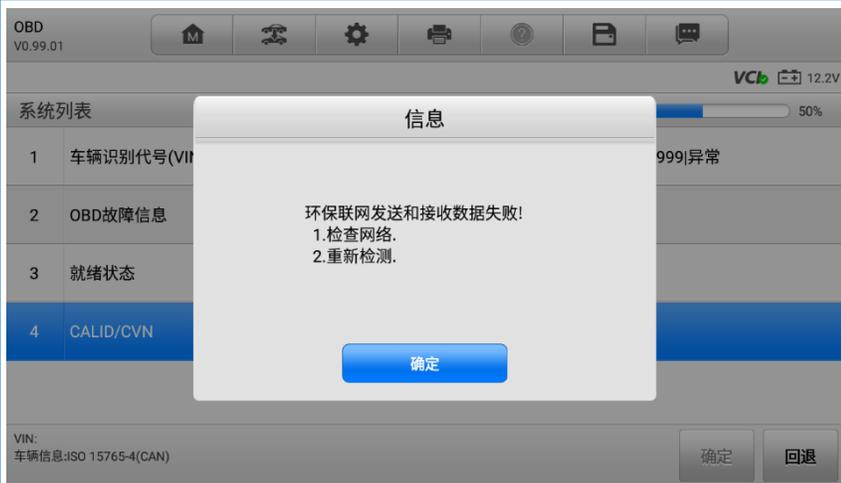
在某一个检测站测试时，当时正在测试一台小车，前面实时数据流传输正常，突然之间就断开异常。经过观察，发现左侧线来了一台大卡车，将信号阻拦。
